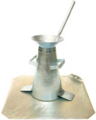
Cono de Abrams-Slump test
