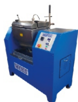
Mezclador de asfalto
